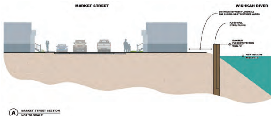
Figura 4. Muro de contención con pilotes de acero a lo largo de las orillas del Río Wishkah
