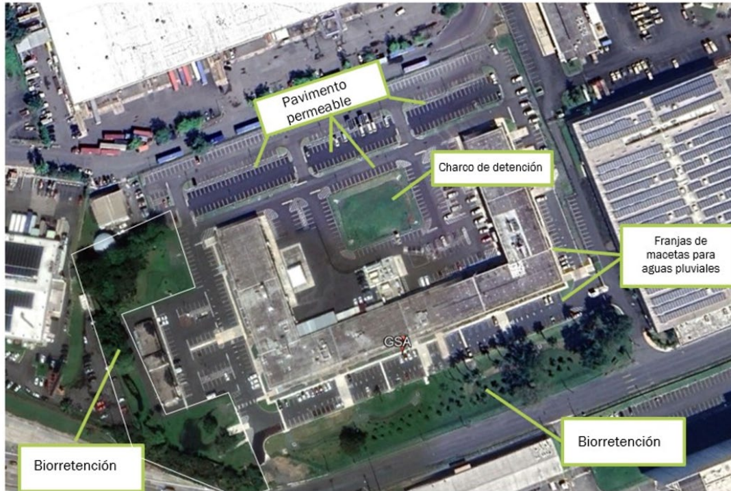
Ilustración 4-1. Vista aérea de las SNBN de la instalación de la GSA
